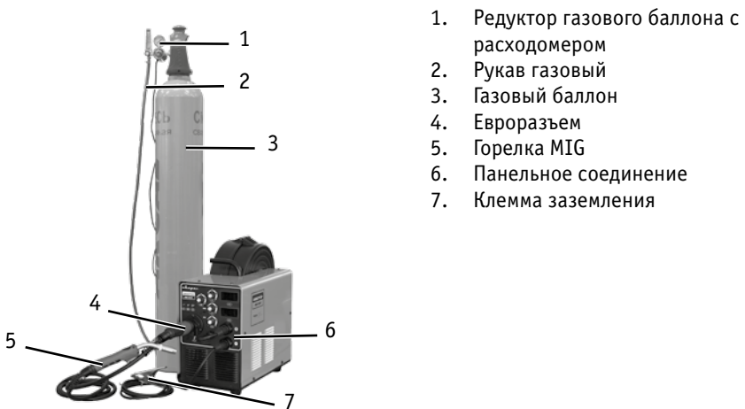
Рис. 3. Схема подключения оборудования для MIG, MAG и FCAW сварки
