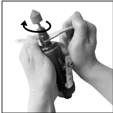
Рисунок 5 – Затягивание цангового зажима
